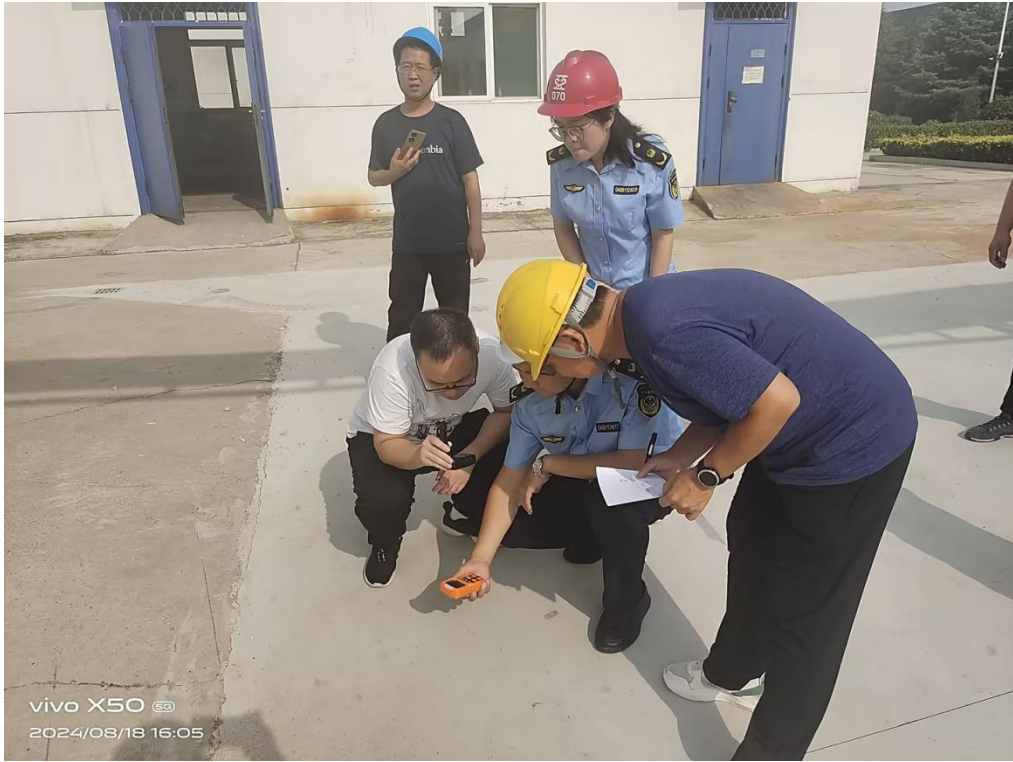
图 6 人员伤亡地点（絮凝池外侧底部）现场有害气体检测
