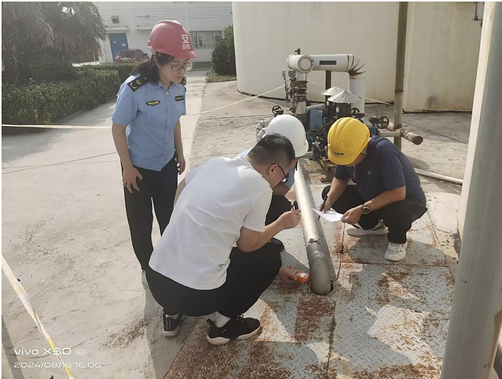
图 8 人员伤亡地点附近（絮凝池外侧底部阀门管井）现场有害气体检测
